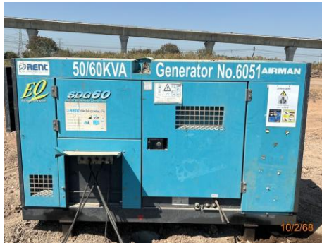
ภาพที่ 2.2-14 การปิดครอบเครื่องจักรเพื่อลดระดับเสียง
